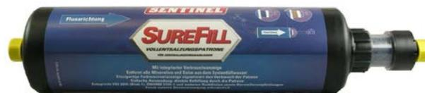
Durch Beseitigung von Kalzium und Magnesium mittels Ionenaustauscherharzen erreicht man, dass sich im Wasser kein Kesselstein bilden kann. Sentinel SureFill ist eine Mischharzpatrone, die fast alle Ionen beseitigt, um das Wasser vollständig zu entsalzen. SureFill setzt keine chemischen Zusätze im Wasser frei und arbeitet ohne externe Stromversorgung.
